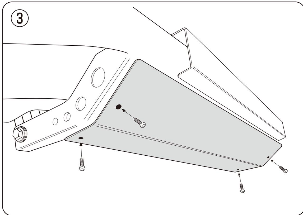
③ 下側にガードを取り付け、画像個所に鍋キャップボルトで取り付けて完成です。
